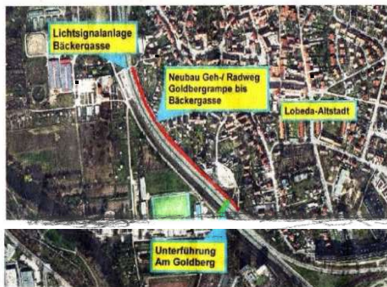
Das ist der Goldbergplan: Zum einen soll der Durchlass (grüne Linie) „im Bestand“ saniert werden. Zum anderen könnte die „Goldberg-Rampe“ als Radweg (rot) bis zur Bäckergasse verlängert werden, wo es eine Ampelquerung über die Stadtrodaer Straße gibt. FOTO: STADTRATSUBTERLAGEN / STADT JENA
